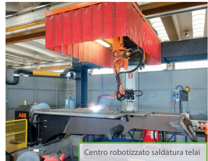
Nuovo centro a doppia robotizzazione automatizzato e ad alta precisione
